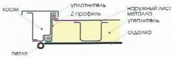
Установка со стороны улицы
